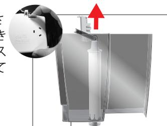
⑧ 中性洗剤を使用し水タンク内部をよく洗います。柄の長いスポンジ等を使用しフィルターの差し込み部もよく洗浄した後、きれいにすすぎます。
