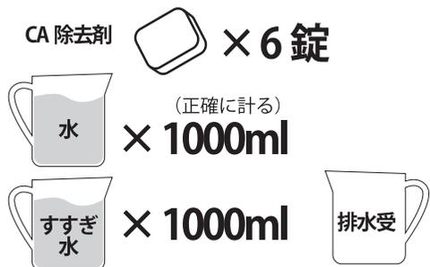
ご使用するに従って飲料水に含まれるミネラル成分がマシン内部に徐々に蓄積されて固着してゆきます。最初に設定した水の硬度によりマシンは自動的にCA(カルシウム)除去洗浄を促します。
