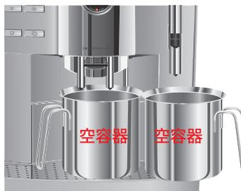
⑥リンスボタンを押します。まずはフローサー下から、次に給湯口からそれぞれ断続的に排水が出ます。
